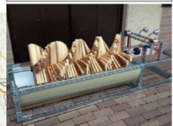
■奈良県吉野町殿川 ・直径 1.6m上掛け水車 ・地域集会所の防災電源
