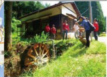
■奈良県吉野町三茶屋 ・直径 3m下掛け水車 ・公共駐車場の外灯
