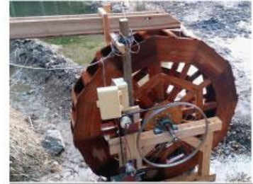
■京都市左京区静原 ・直径 1.5m上掛け水車 ・電気柵電源
