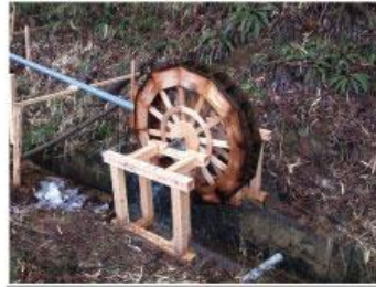
■京都市左京区静原 ・直径 1.5m中掛け水車 ・電気柵電源
