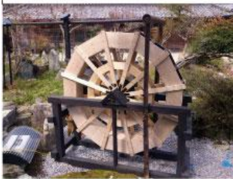
■奈良県吉野町竜門 ・直径 1.7m上掛け水車 ・敷地内の外灯、電気柵
