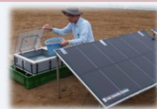
セシウム除去装置
